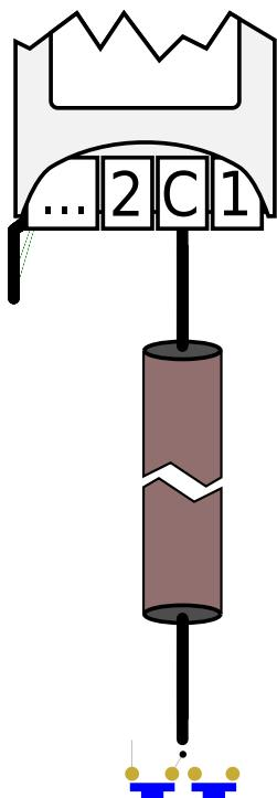
El dispositivo base incorpora 2 entradas digitales en su configuración por defecto. Estas entradas son para contactos libres de tensión.
