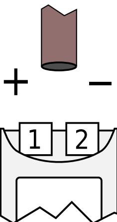
En la versión DC por el contrario, si que existe una disposición de los cables de alimentación que se debe respetar, si no se respetan el equipo no funcionará y por tanto no estará activo.
