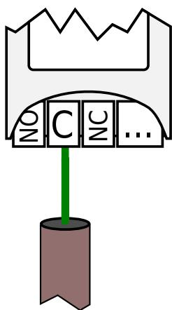
La mayoría de los dispositivos cuentan con un relé conmutado con el que podemos comandar cualquier elemento con la borna auxiliar. En esta borna esta presente el contacto conmutado del relé.
